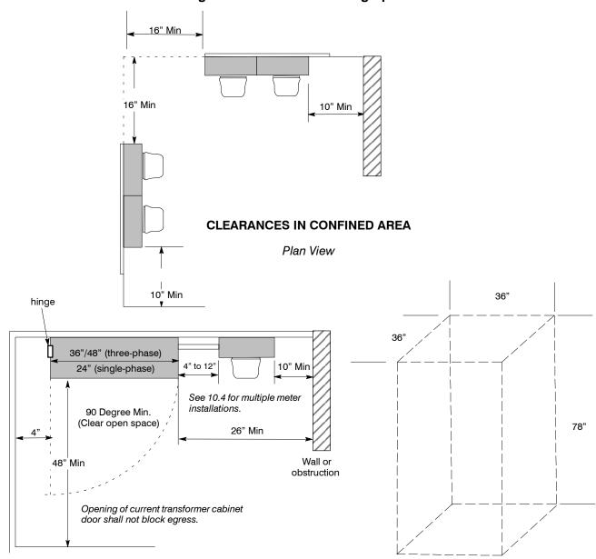
Figure 5.1.2 - Meter Working Space
