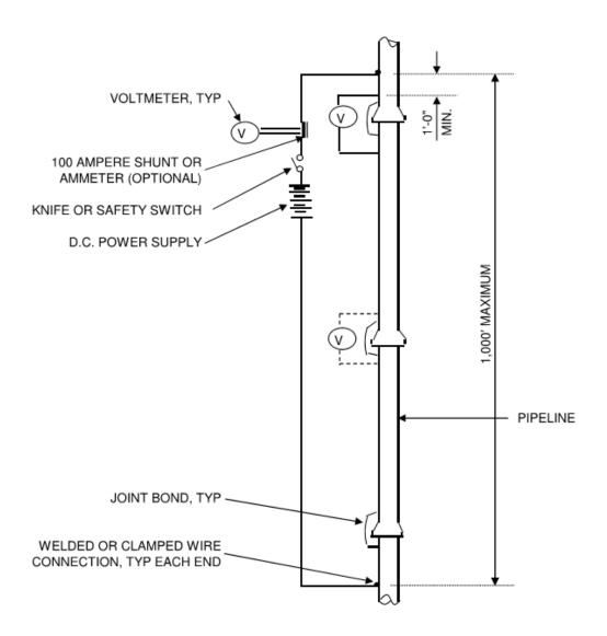
JOINT BOND CONTINUITY TEST SCHEMATIC
